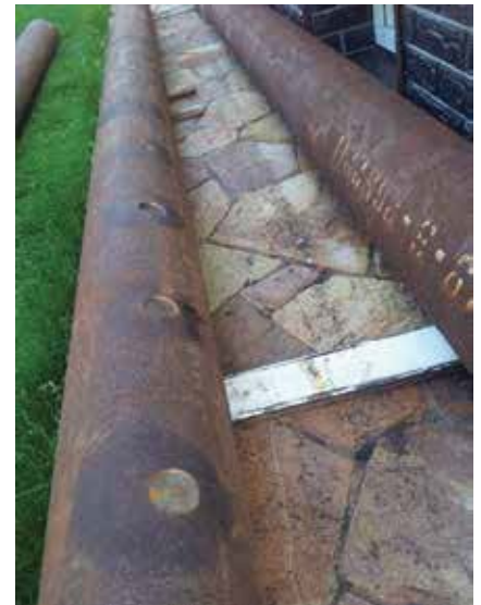
Рис. 9. Образцы труб с искусственными дефектами
